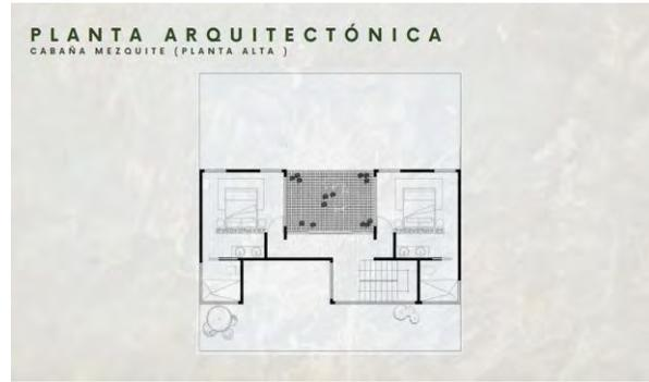
Figura 4 Planta arquitectónica – Planta alta: Distribución enfocada en el confort privado, ventilación cruzada y vistas. Elaboración propia.
