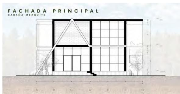
Figura 1. Fachada principal: Muestra la volumetría frontal con orientación solar adecuada y materiales naturales. Elaboración propia
