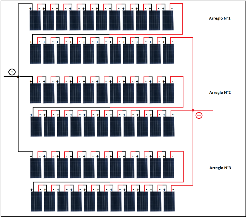
Figura 4. Diagrama esquemático del SFV serie-paralelo.
